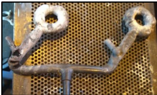
Figura 17. Modelo real de mechero de precalentamiento. [Fuente]: realizada por el autor (14/06/2019).
