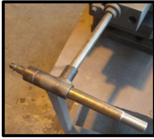
Figura 7. Venturi insertado en molde. [Fuente]: realizada por el autor (21/05/2019).
