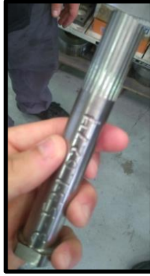
Figura 8. Chimenea para molde. [Fuente]: realizada por el autor (24/05/2019).
