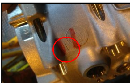
Figura 8. Defecto de “pliegue”. [Fuente]: realizada por el autor (28/05/2019).
