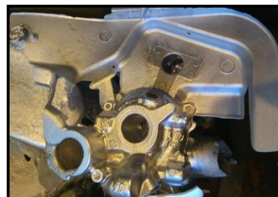
Figura 7. Defecto de “macho explotado”. [Fuente]: realizada por el autor (28/05/2019).
