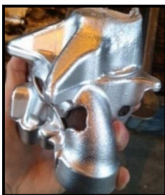
Figura 6. Defecto común de “falta de llenado”. [Fuente]: realizada por el autor (28/05/2019).
