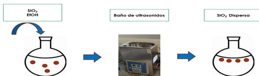
FIGURA A.6. Esquema del proceso de obtención de emulsión de sílice: \text{SiO}_2/\text{EtOH} 10/90 (% peso).
