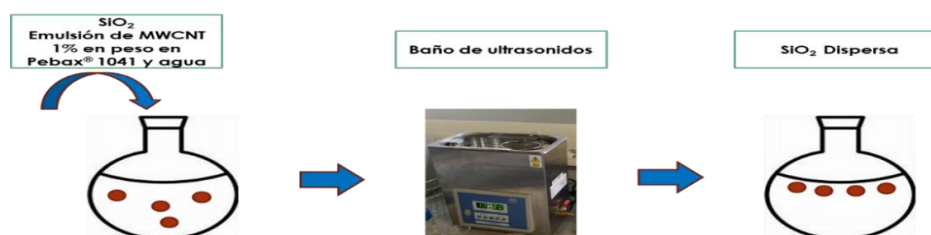
FIGURA A.8. Esquema del proceso de obtención de las emulsiones de sílice + MWCNT: SiO 2 /emulsión de MWCNT 1% 5/95 y 10/90 (% peso).
