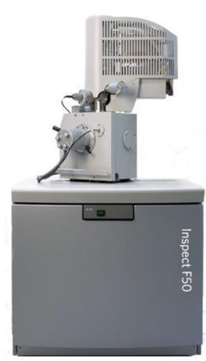
FIGURA A.14. Microscopio electrónico de barrido Inspect 50 (FEI) del INA.
