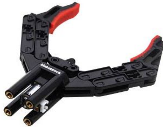
Ilustración 33: Ejemplo garra mecánica con almohadillas. (Reichelt, n,d)
