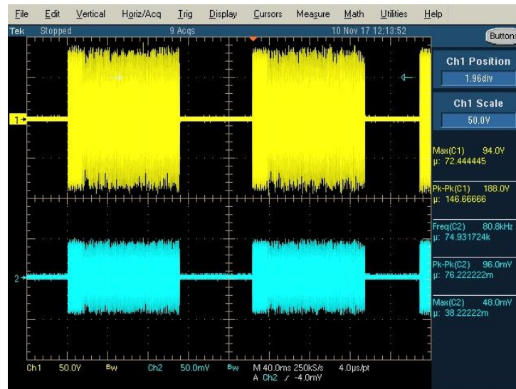
Figura 23 Salida tensión e intensidad transformador 1 1:19
