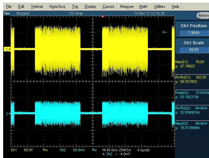
Figura 22 Salida tensión e intensidad transformador 1 1:11
