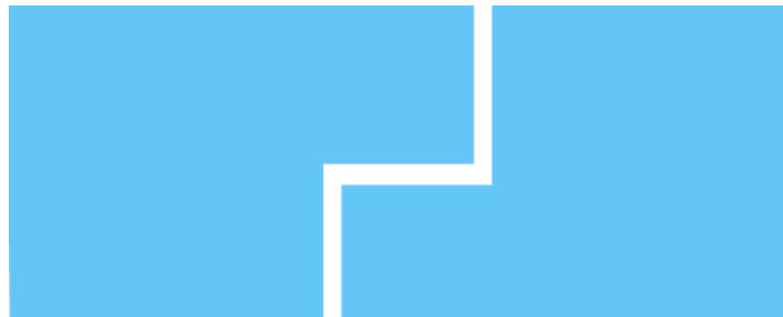
Juntas perimetrales a media madera
