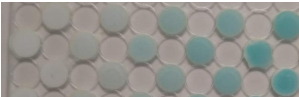
Figura 18. Placa con la recta de calibración. [\text{TMB}] = 6 \cdot 10^{-4} \text{ M} , [\text{HRP}] = 0,6 \text{ U/mL} , [\text{Cel}] = 3\% , \text{pH} = 6
