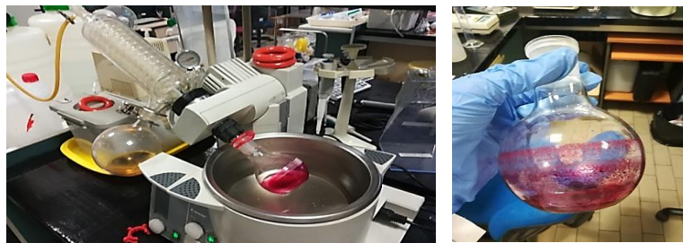
Figura 14. Evaporación en rotavapor de sobrenadantes (35 °C).
