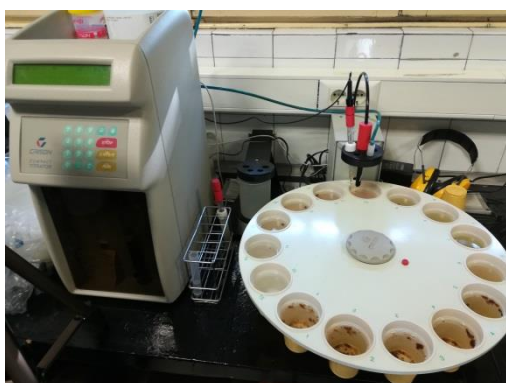
Figura 11. Titulador automático Compact Titrator.
