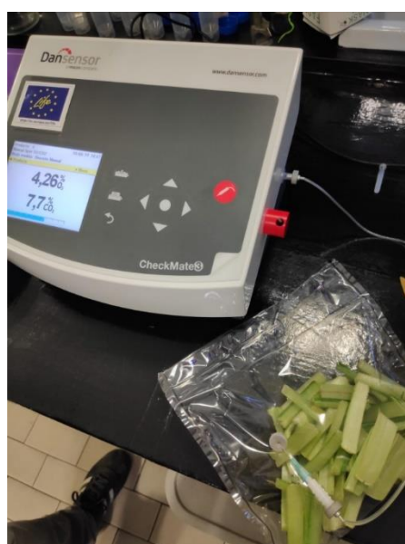
Figura 7. Medida de la composición gaseosa del interior de una bolsa de tallos de borraja.
