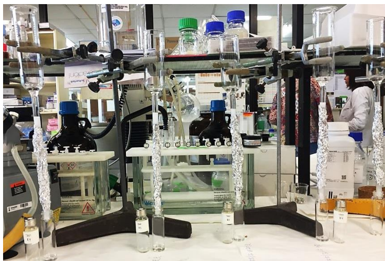
Imagen 9. Preparación de las columnas para la extracción y separación de los hidrocarburos de aceites minerales.
