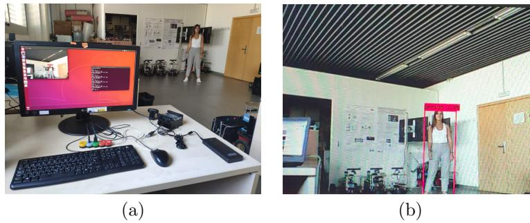
Figura 3.4: Prototipo desarrollado, montado en el laboratorio del grupo Ro-PeRT. (a) Prototipo desarrollado detectando una persona en vídeo a través de la webcam. (b) Captura del vídeo detectado en el prototipo.
