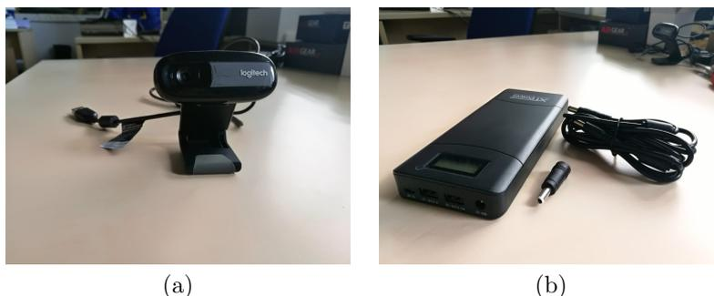
Figura 3.2: Cámara y batería utilizadas en el prototipo desarrollado. (a) Webcam logitech C170 . (b) Batería XT-20000Q3-PA
