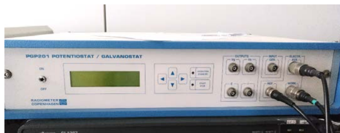
Figura 3.3. Equipo de medidas de corrosión VoltaLab, del área de Ciencia de Materiales e Ingeniería Metalúrgica (EINA, Universidad de Zaragoza). A l derecha se ven las conexiones de los electrodos.
