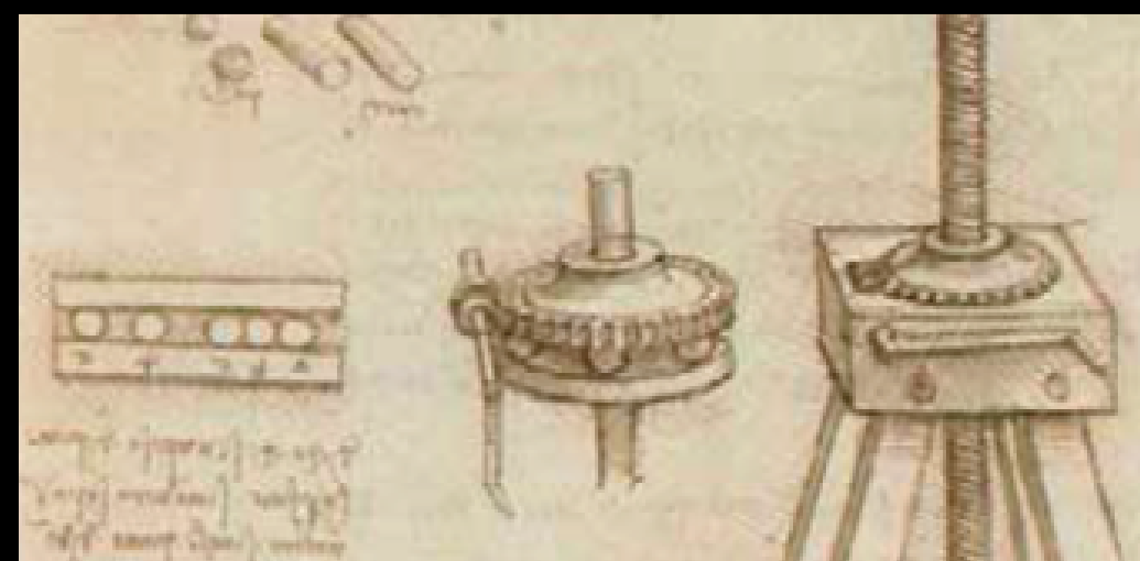
GATO DE TORNILLO CON RODAMIENTO ANTIFRICCIÓN Cód. Madrid I, f. 0026r
