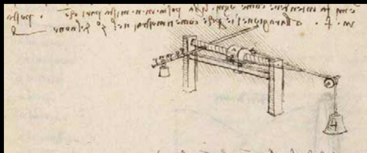
ENSAYO PARA MEDIR LA FUERZA DE UN TORNILLO. Cód. Madrid I, f. 0004v.
