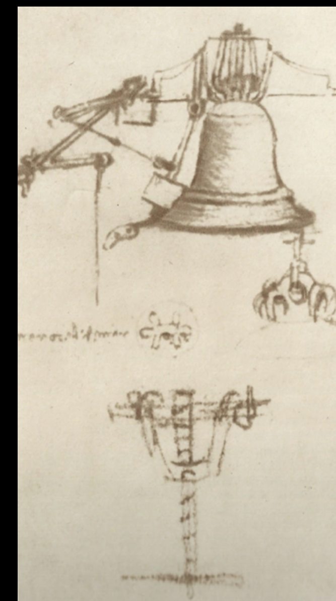
MARTILLO MECÁNICO PARA TOCAR CAMPANAS. Cod. Forster II, f.10 v.
