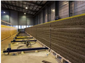
Fig 88 Módulos prefabricados en taller. Fuente: www.lehmtonerde.at
