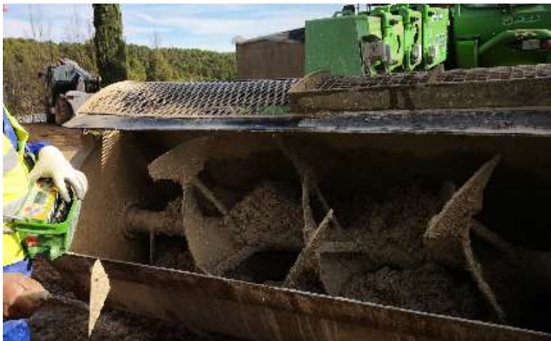
Fig 38 Cazo amasador del mortero de cal y cáñamo. Fuente: Documentación gráfica de la empresa Elecnor.
