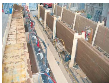
Fig 76 Construcción prefabricada con tapial. Fuente: Paredes de tapial y su industrialización (M. Rauch, 2011)
