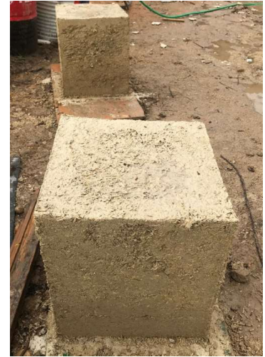
Fig 50 Probetas de 30 x 30 x 30cm. Fuente: Documentación gráfica de la empresa Elecnor.
