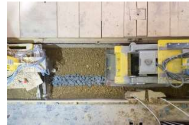
Fig 97 Proceso de compactación. Fuente: http://www.lehmtonerde.at/de/projekte/projekt.php?PID=97
