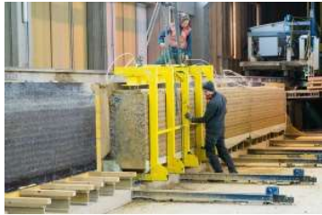
Fig 94 Muros prefabricados para Alnatura. Fuente: http://www.lehmtonerde.at/de/projekte/projekt.php?PID=97
