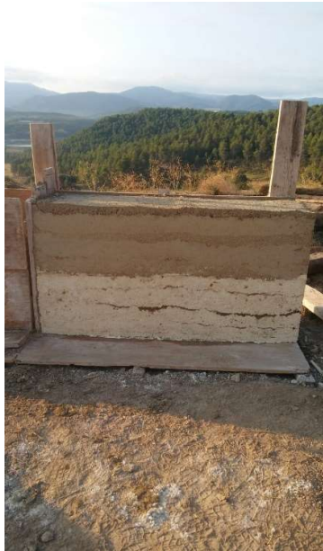
Fig 48 Prototipo de tapia con distintas cales. Fuente: Documentación gráfica de la empresa Elecnor.
