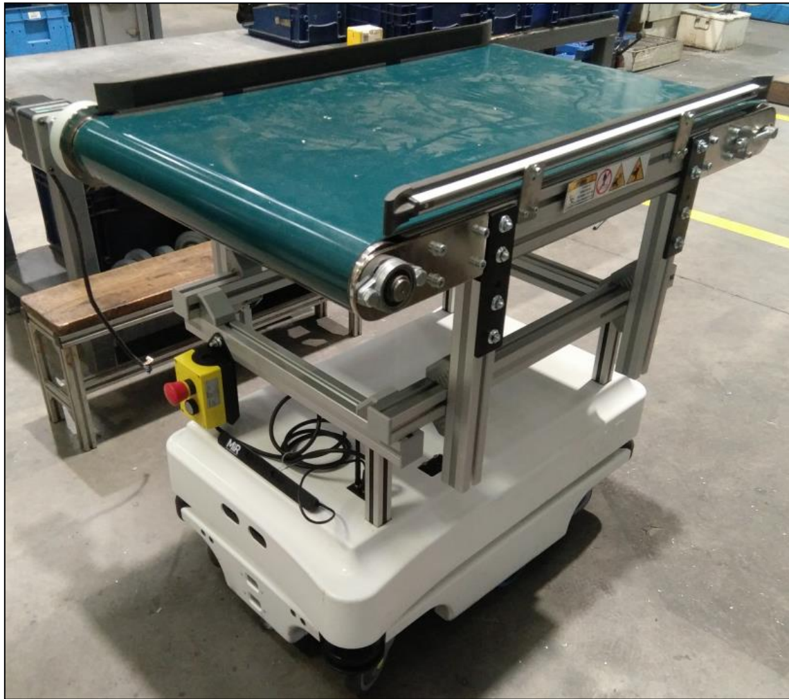
(Figura 2.2: Montaje del MIR + estructura portante + cinta transportadora)
