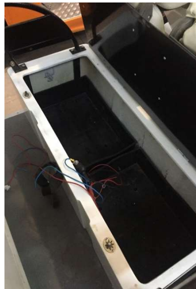
Ilustración 8: Cajón compartimentado para baterías
