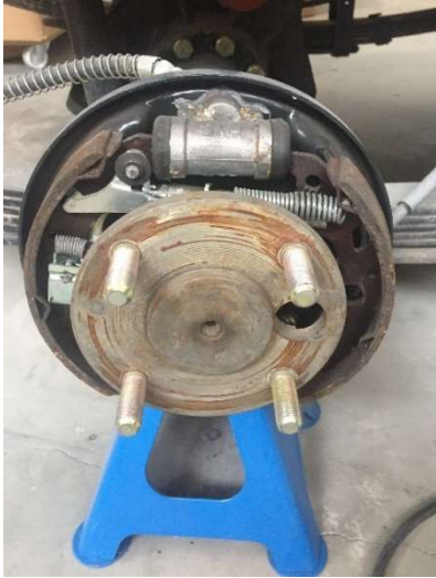
Ilustración 3: Freno trasero en mal estado
