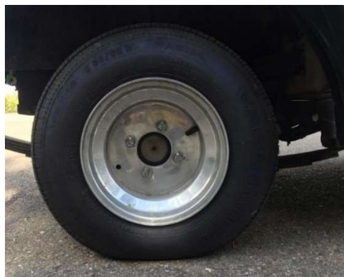
Ilustración 21: Neumático deformado Zylog cargado
