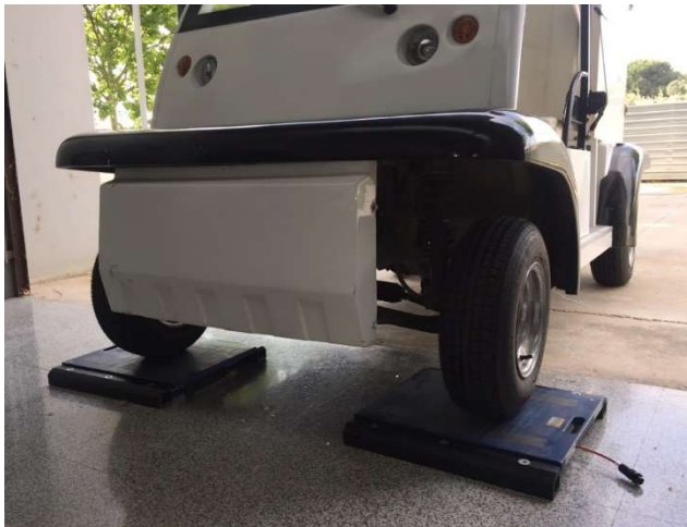
Ilustración 18: Proceso de tara Zylog
