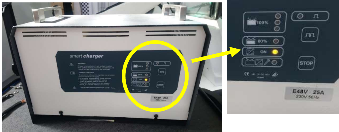
Ilustración 44: Inicio del proceso de carga
