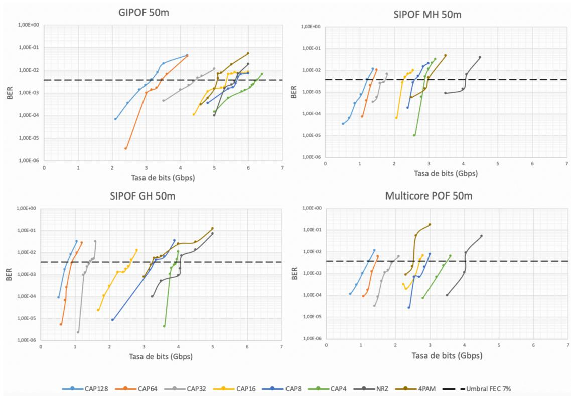
Figura 4.1. Relación BER con tasa de bits para las cuatro fibras
