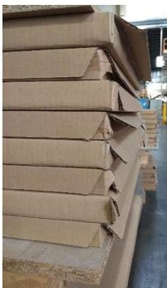
**Figura 28. Solapas de las cajas despegadas**
