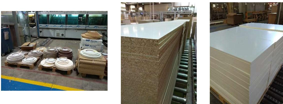
**Figura 41. A la izquierda el canto en materia prima, en el medio tablero sin cantear y por último, el tablero con el canto pegado**
