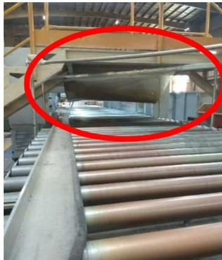
Figura 21. Tope para presionar las cajas en la plegadora
