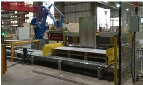
Figura 23. Almacén de palets del robot
