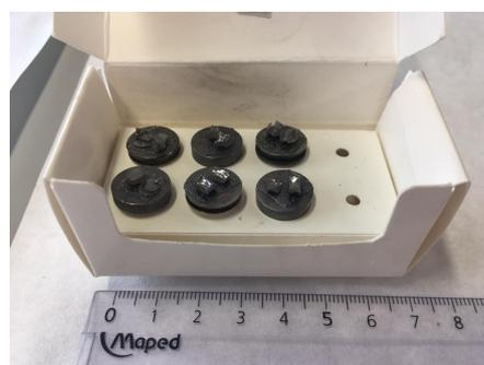
Figura 17: Conjunto de pruebas previas a la microscopía electrónica, a) muestras de 1:1,06 30-70 (%) y 1:1,04 30-70 (%) respectivamente tras el proceso de liofilización, b) muestras cortadas y recubiertas metálicamente.
