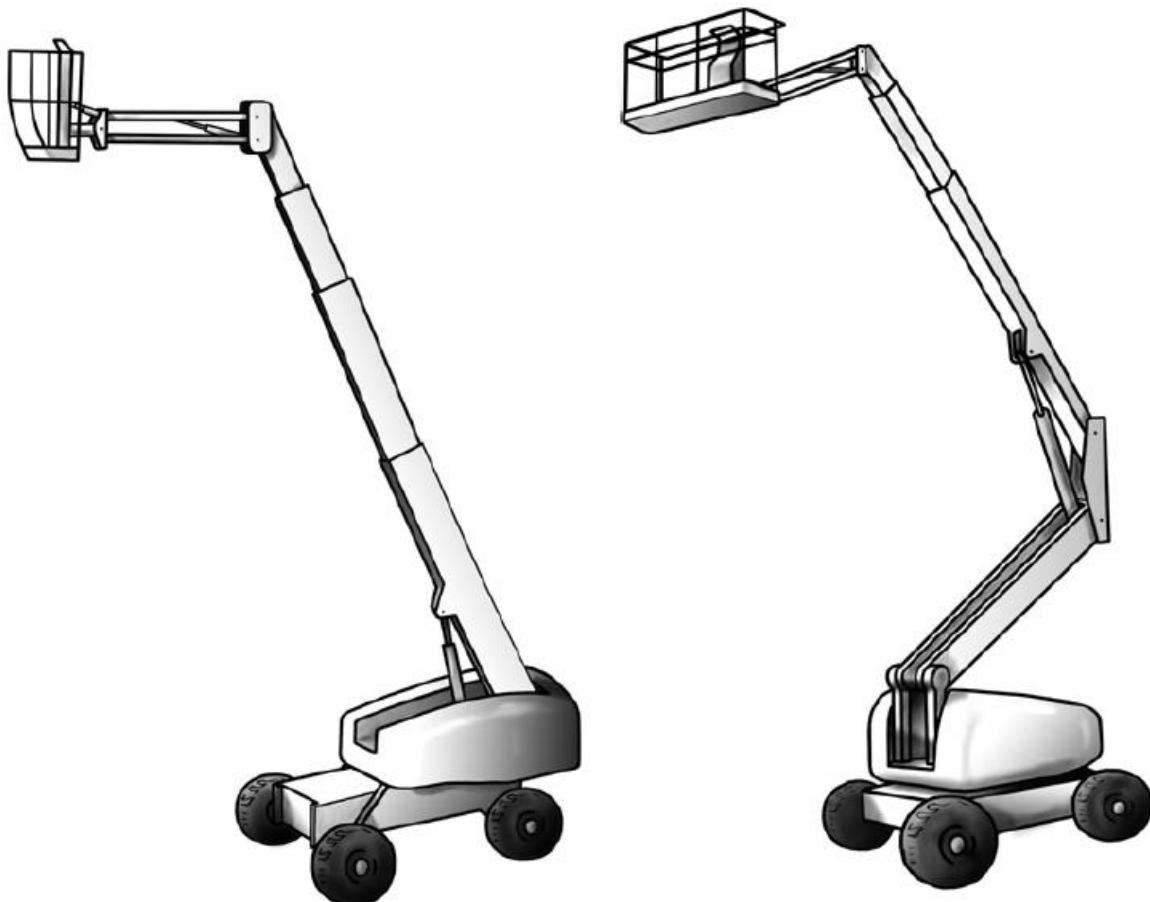
Figura 2.2 (2): Plataforma de brazo telescópico (izquierda) y plataforma de brazo articulado (derecha) o de grupo B
