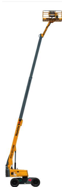
Figura 2.4 (1): PEMP telescópica en una posición de trabajo
