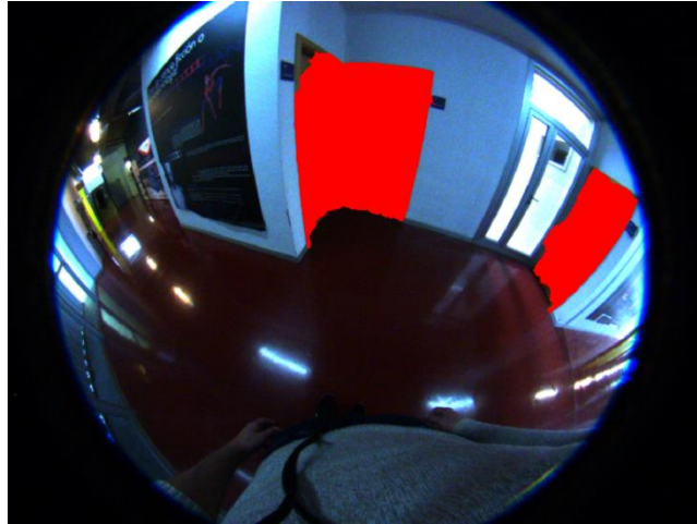
Figura 0.5. Segmentación de las posibles puertas (en rojo) tras aplicar el criterio del cross ratio a la Figura 3.3
