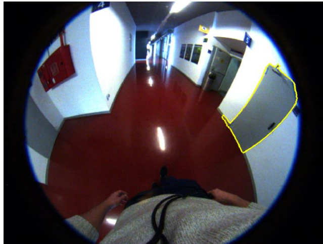
Figura 0.6. Resultado del segundo método de detección de puertas para la Figura 4.1b
