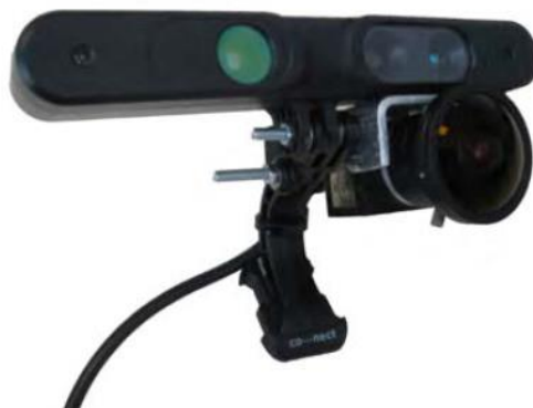
Figura 0.1. Sistema de cámaras utilizado en el proyecto, compuesto por una cámara fisheye y una cámara RGB-D
