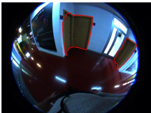
Figura 0.7. Ejemplos de imágenes tras aplicar el primer algoritmo de detección de puertas (en rojo)
