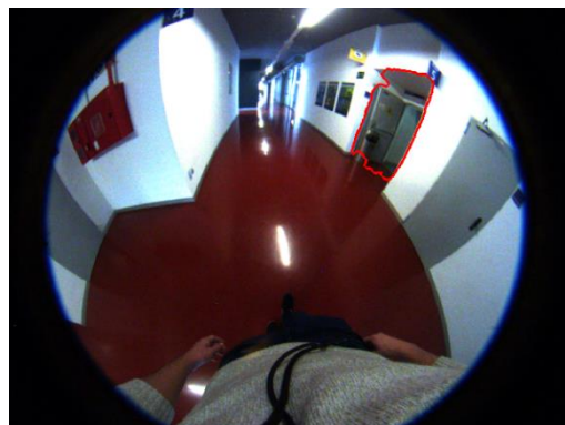
Figura 0.7. Ejemplos de imágenes tras aplicar el primer algoritmo de detección de puertas (en rojo)
