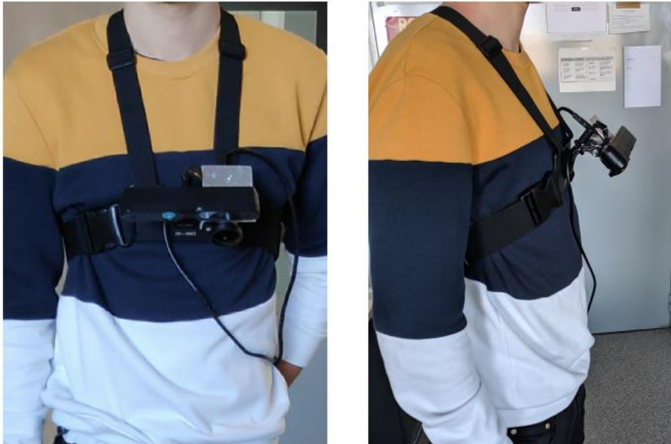
Figura 0.2. Posición del conjunto de cámaras sobre el sujeto
