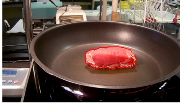
Figura A.4: Reconocimiento de los contornos en uno de los frames de la imagen del perfil.
