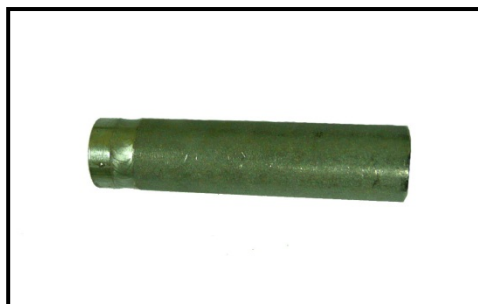
Figura 1: Tornillo de acero macroporoso inoxidable 316L. Un extremo está cerrado manteniendo el otro extremo abierto y una hoquedad interior.
