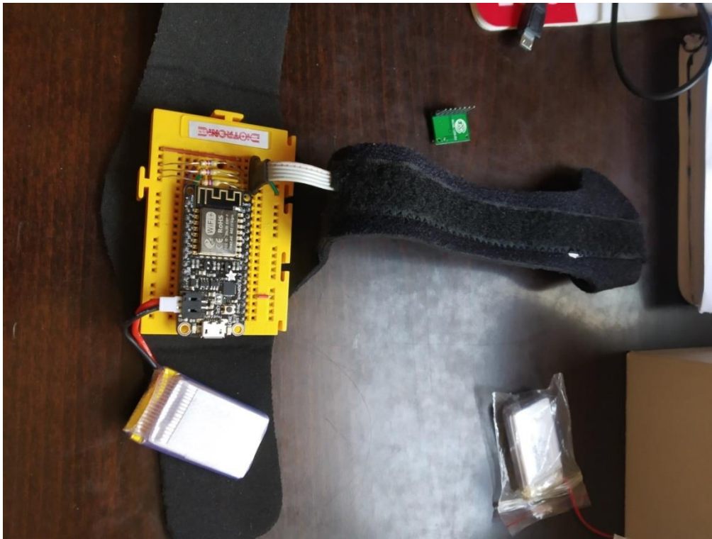
Fig 22. Férula de dedo con sensor en la punta y protobard con circuito del prototipo
