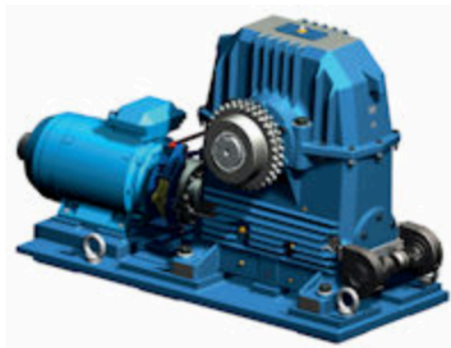
Figura 1.1: El ejemplo del reductor de la escalera mecánica
