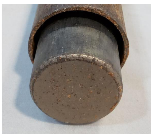
Fotografía 7.15. Maza P.M. 3:1 tras compactar una tongada con w_{op}
