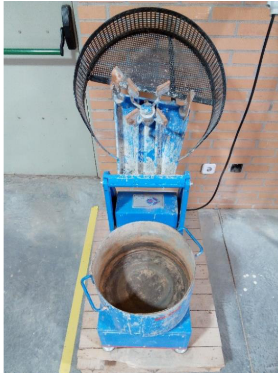
Fotografía 5.11. Amasadora usada en la investigación
