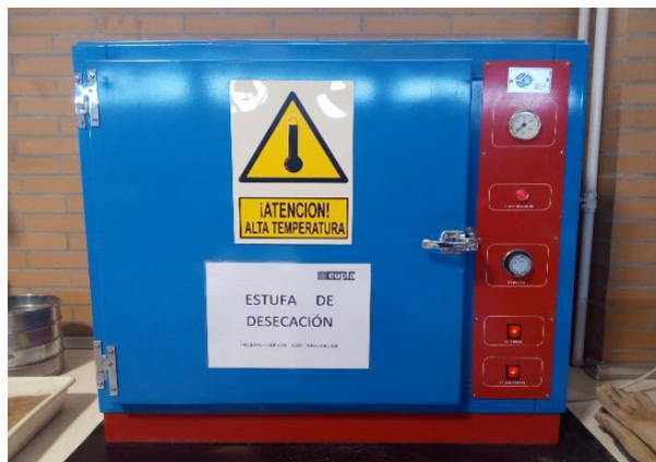
Fotografía 5.13. Estufa de desecación usada en la investigación
