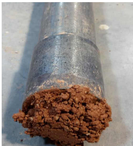
Fotografía 7.16. Maza P.N. 1:1 tras compactar una tongada con w_{op}
