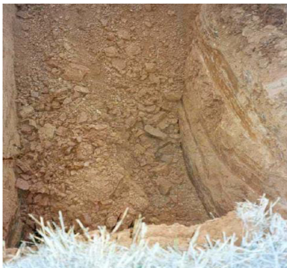
Fotografía 5.1. Calicata realizada en el Proyecto de Construcción de la A-23. Tramo Paniza-Torrubia
