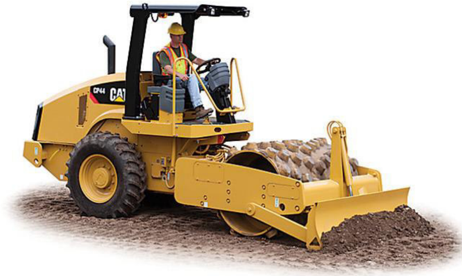
Figura 4.32. Compactador vibratorio de tambor único, pata de cabra (CAT, 2019)
