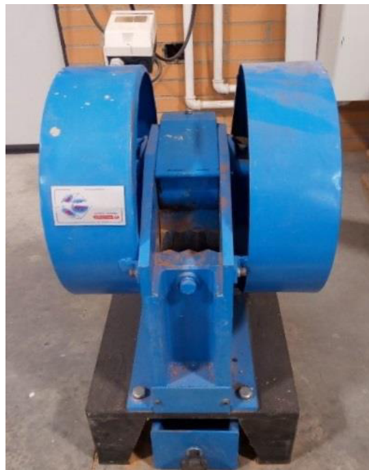
Fotografía 5.9. Machacadora de mandíbulas utilizada en la investigación
