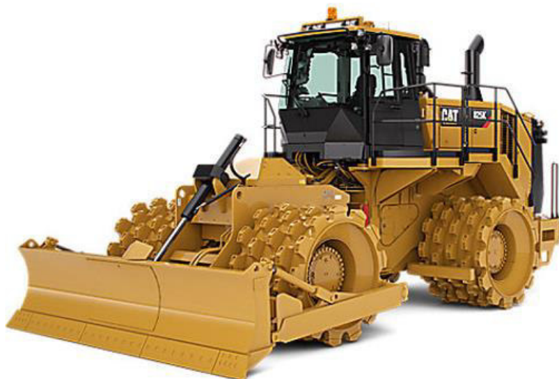
Figura 4.31. Compactador pata de cabra (pisones o pies "tamping" (CAT, 2019)
