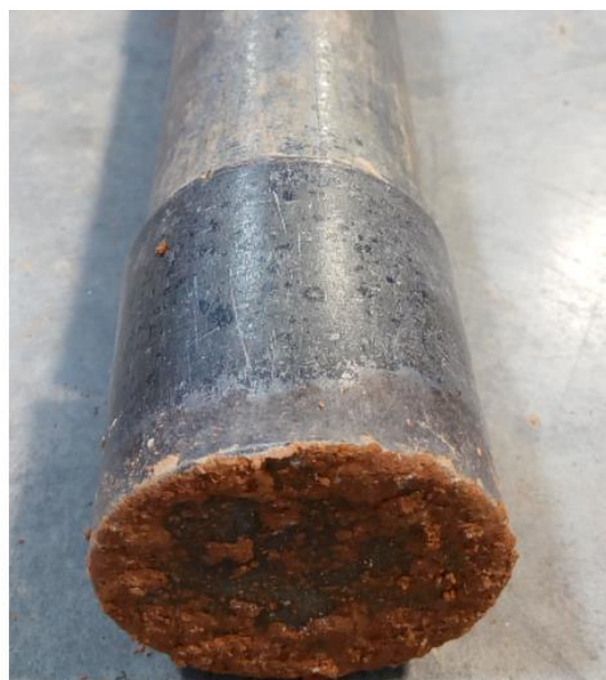
Fotografía 7.17. Maza P.N. 3:1 tras compactar una tongada con w_{op}
