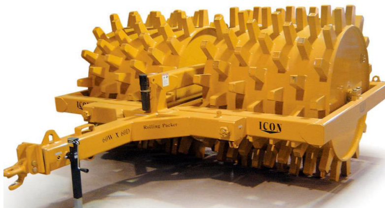
Figura 4.33. Compactador pata de cabra remolcado (Rojo López, 1988)
