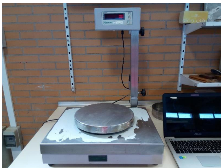
Fotografía 5.10. Báscula de pesado Gibertini TMB 45N
