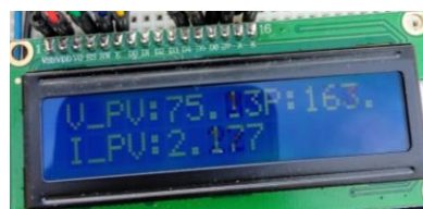
Figura 42. Foto pantalla LED con medidas de Tensión corriente y potencia los paneles solares. Fuente propia
