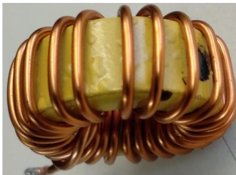
Figura 27. Detalle Burbujas y pintura levantada en el núcleo por el calentamiento. Fuente propia.
