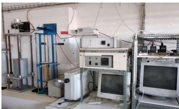
Figura 7: Sistema termogravimétrico, horno, toma de datos y medidores de flujos
