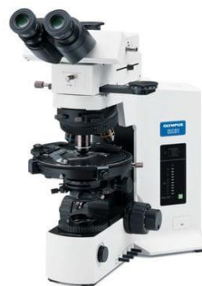
Figura 21: Microscopio petrográfico Olympus (Bx51) (Group Virtual Expo, 2018).
