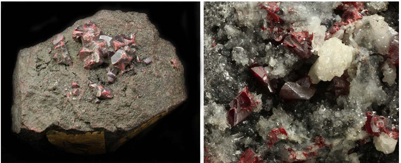
Figura 6. Ejemplares de cinabrio de la mina de Almadén. A la izquierda, ejemplar con cristales de alrededor de 7 mm. En la derecha, pueden verse cristales de cinabrio asociados a cristales de cuarzo. Área fotografiada, 2,5 cm.
