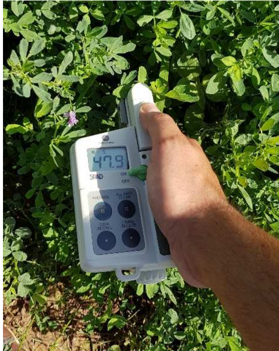
Figura 21: Konica Minolta SPAD 502 para medir clorofila
