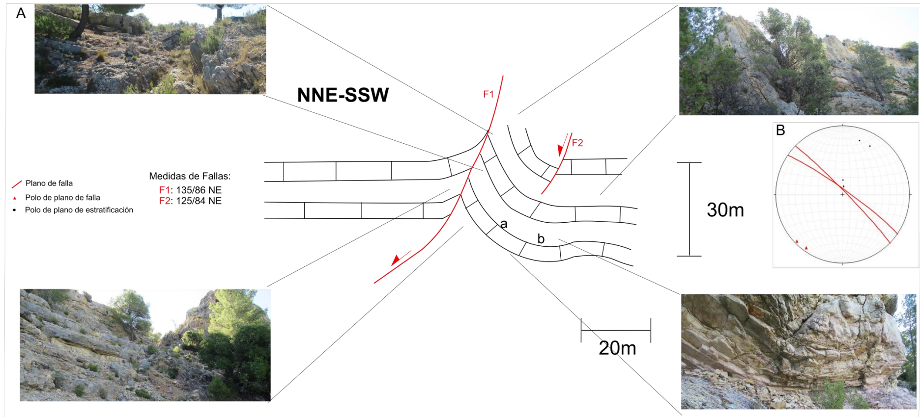
Figura 11: (A) Interpretación y fotografías de cada lugar del afloramiento, donde se observan las estructuras de compresión. Medidas de estratificación en a: 120/70S y b: 098/10SW. (B): Proyección estereográfica de los planos de falla y estratificación.
