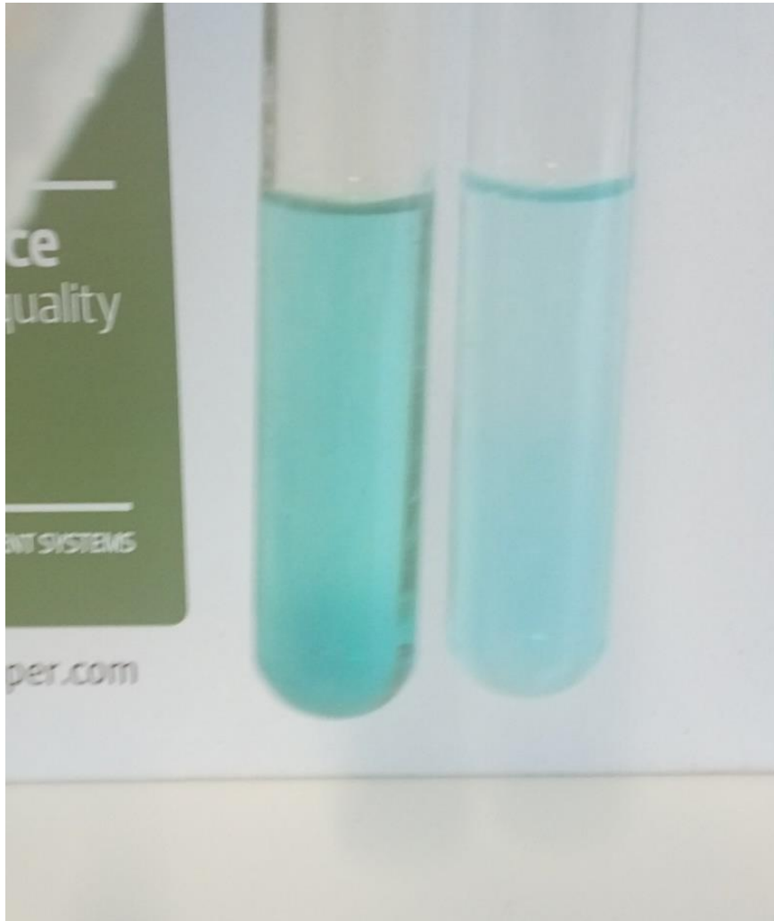
Imagen 1: Tubos con el mismo volumen de ácido, pero distinta cantidad de cobre.
