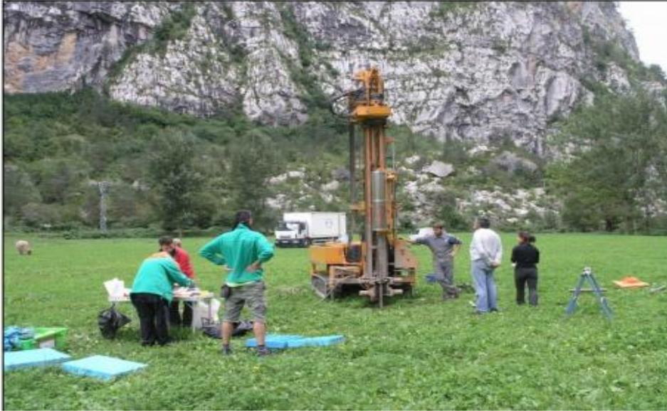
*Figura 23: Fotografía de la maniobra de extracción del sondeo de Plandescún.*
