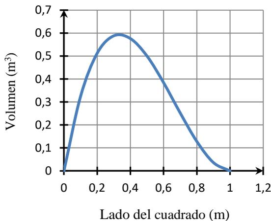
El volumen va aumentando conforme se aumenta el lado del cuadrado que recortas hasta un poco más de 0,3 m, después vuelve a disminuir hasta obtener
