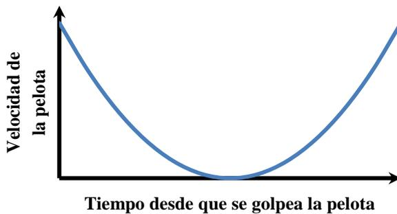
Al principio la velocidad de la pelota es alta ya que el jugador se la proporciona. Después va bajando la velocidad hasta que llega al punto más alto de la trayectoria en el cual la velocidad es cero. Cuando pasa ese punto la velocidad comienza a aumentar por la caída de la pelota, hasta que llega a canasta.
