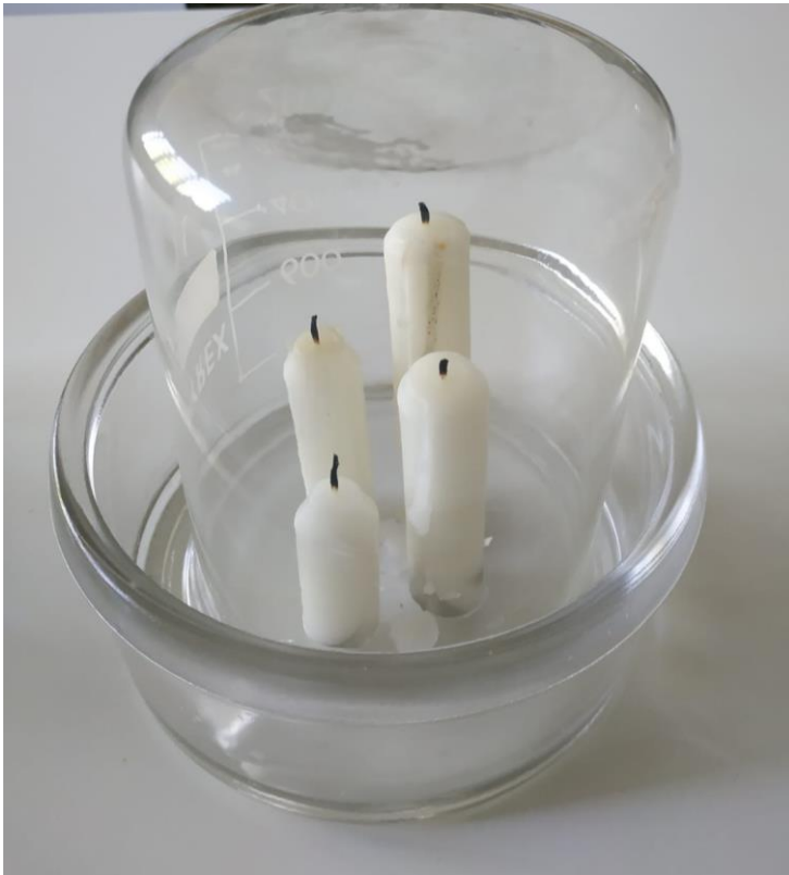
Ilustración 4. Extinguir la llama con cuatro alturas distintas
