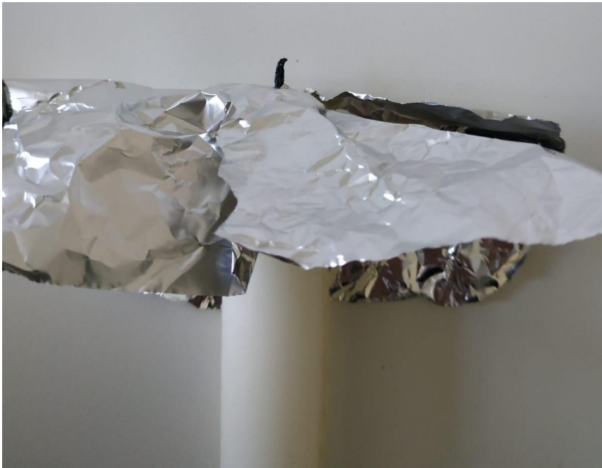
Ilustración 2. Extinguir la llama evitando la evaporación de la parafina
