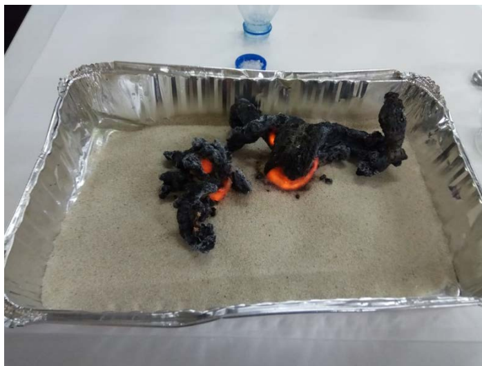
Imagen 7: Las pastillas, inicialmente blancas y del tamaño del tapón que se observa en la parte superior, han aumentado considerablemente de tamaño tras la combustión, formando ese sólido negro hueco por dentro.
