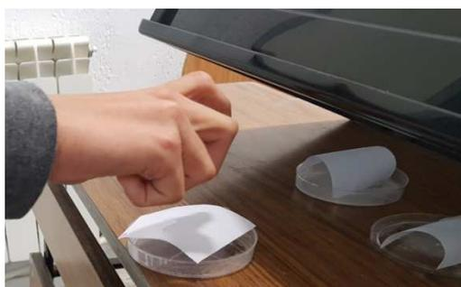
Imagen 2A. Pulverización de  $\text{AgNO}_3$  sobre el papel con la huella.
