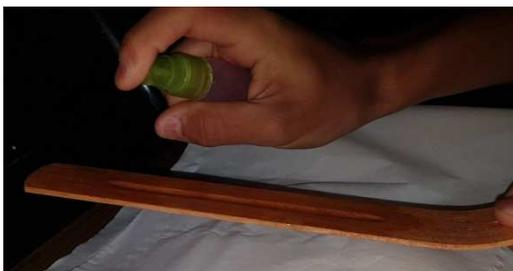
Imagen 3A. Pulverización del luminol sobre el soporte de madera.
