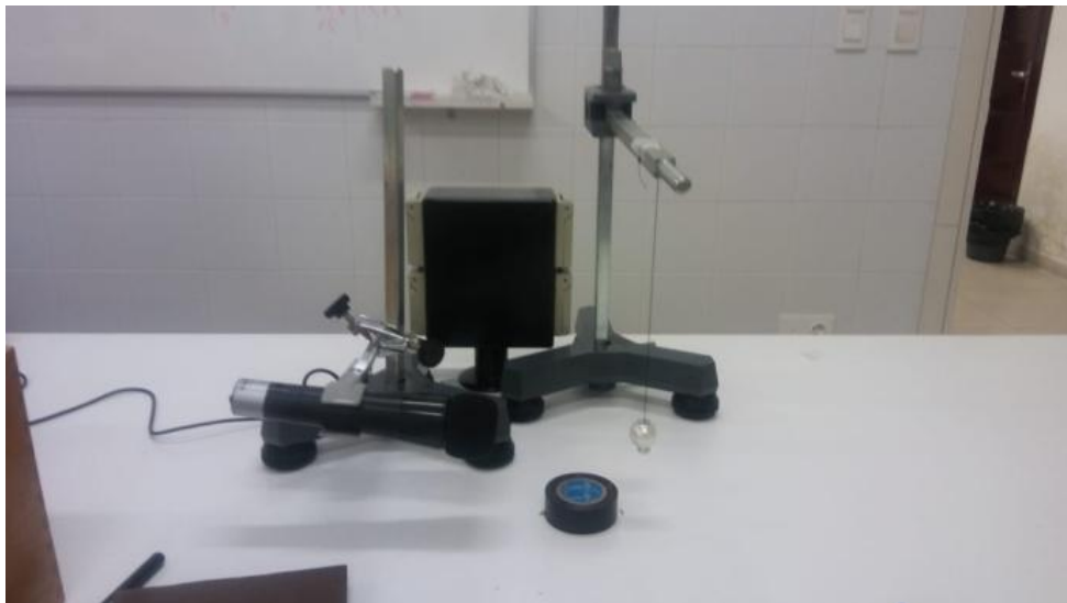
Imagen 4: Péndulo formado por hilo y bola pequeña en el extremo, utilizado en el método 3
