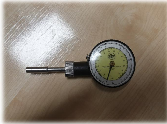
Ilustración 6.- Penetrómetro utilizado para las medidas de firmeza de las manzanas.
