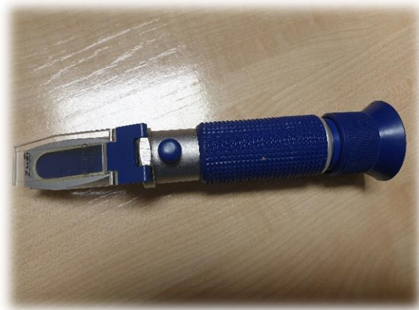
Ilustración 5.- Refractómetro utilizado para obtener los grados Brix de las manzanas.
