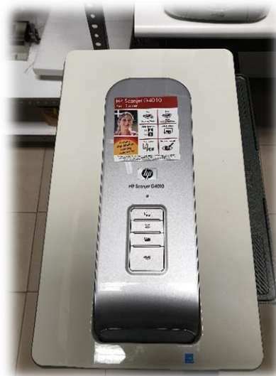
Ilustración 7.- Escáner utilizado para obtener las imágenes de la pulpa de las manzanas que luego se analizan en ordenador.
