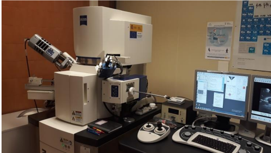
Figura 3. FESEM Carl Zeiss MERLIN™ en el Servicio de Microscopía Electrónica de Materiales (SAI, Universidad de Zaragoza).
