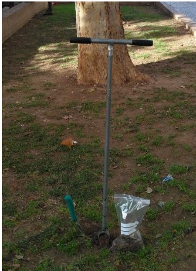
Figura 2. Materiales utilizados en la toma de muestras. Se observa el auger y la bolsa que alberga la muestra.
