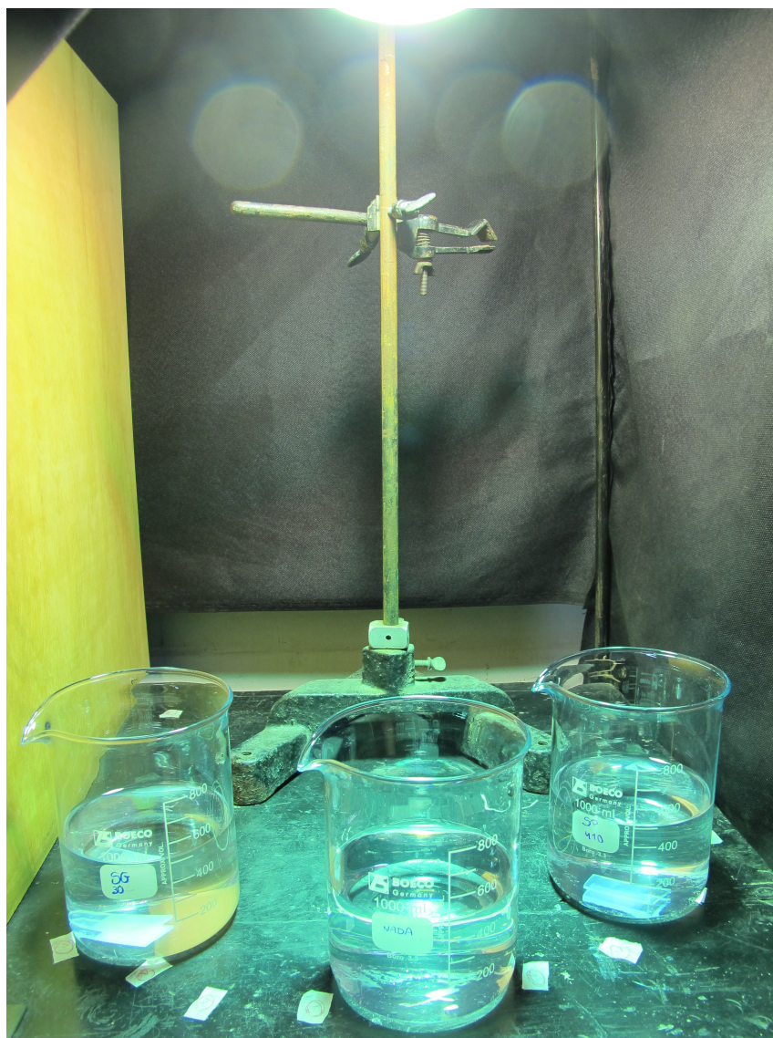
Figura 15 : Los 3 vasos de la prueba se colocan en un espacio cerrado y oscuro, debajo de una lámpara UV-Visible, de tal manera que todos estén irradiados con la misma intensidad de luz.
