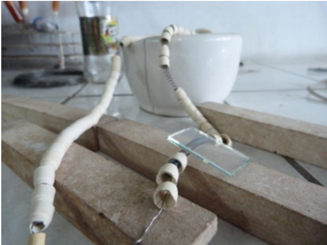
Figura 9 : Para cortar las muestras con el fin de observar su sección transversal, se empleó un sistema de corte por resistencia “casero”. Una cara del vidrio se calienta por la resistencia mientras que se proyecta aire frío sobre la otra. Se produce entonces un choque térmico que conduce a la rotura.
