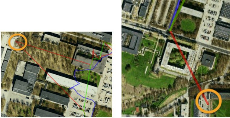
Figura 2.6: Filtro WiFi. Dos ejemplos de posiciones muy imprecisas (dentro de los círculos amarillos) en las rutas: from 343 to 308 (izquierda) and from Nils Koppels Alle to Knuth-Wintherfeldts (derecha)
