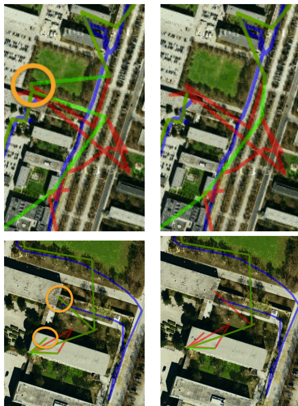
Figura 2.7: Dos ejemplos en los que se ha eliminado posiciones obtenidas utilizando posicionamiento Wi-Fi (dentro de los círculos amarillos) en las rutas: from 341 to 101 (arriba) and from 343 to 308 (abajo)
