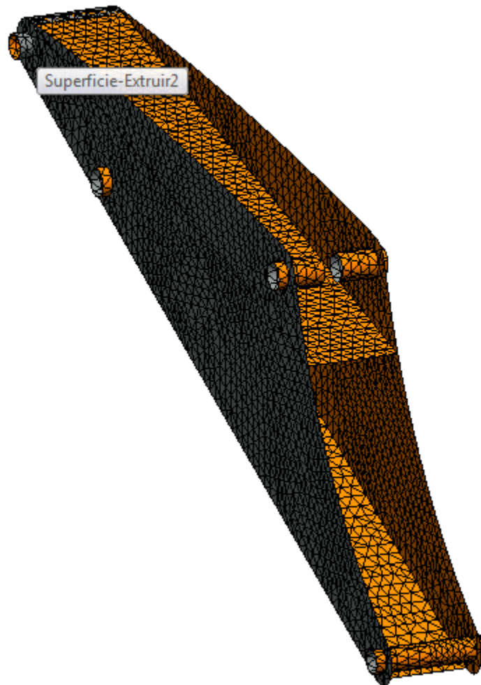
Figura 105 – Mallado vibraciones elemento HJKM posición 4
