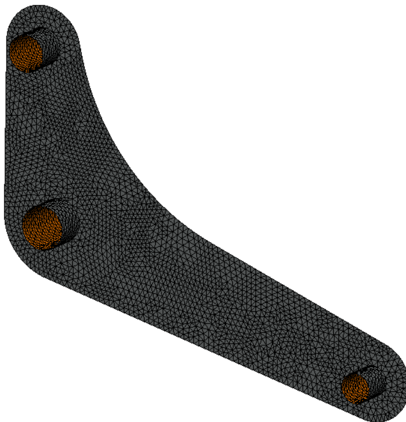
Figura 128 - Mallado Elemento DEF
