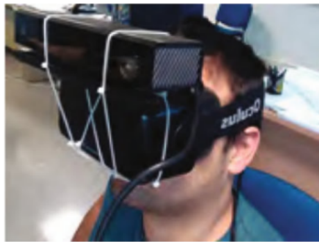
FIGURA 1.2: Ejemplo de configuración de un SPV desarrollado por Bermudez et al. [1]. Este dispositivo está compuesto por una cámara Microsoft Kinect 2 y unas gafas de realidad virtual Oculus Rift.
