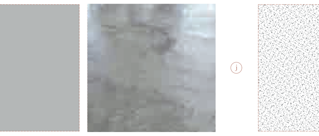
i Hormigón fratasado con pigmentación blanca. Refuerzo con fibra de vidrio. Pavimento sala de instalaciones, entrada y núcleos de comunicación.
