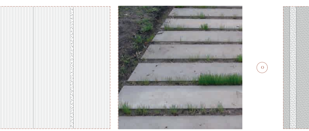
n Ishi Llosa Vulcano color ceniza 60 x 30 x 5 cm. BREINCO SMART. Se disponen dos losas juntas. La separación entre parejas de losas es de 25mm.
