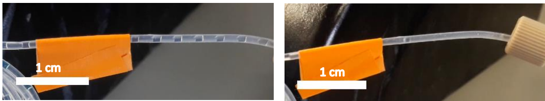
Ilustración 13. Fotografías de los resultados obtenidos del sistema de flujo 1 (fases líquido-gas). Flujo segmentado y no homogéneo.
