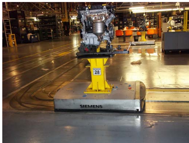
Plataforma sobre la que se dispone el motor en PRE-EDU
