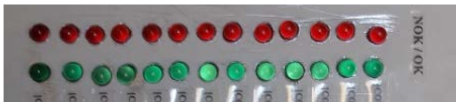
Indicadores del estado de las conexiones del mazo de cables
