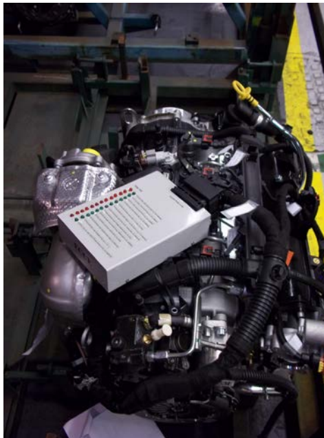
Prueba de todas las fichas sobre motor fuera de línea
