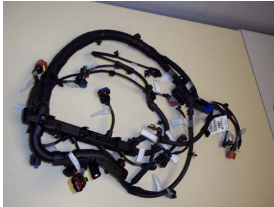
Mazo de cables MBP con fichas identificadas
