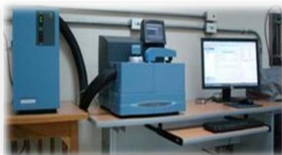
Para la determinación de la capacidad calorífica se necesita una calibración adicional, en este caso utilizando zafiro como compuesto de referencia.
