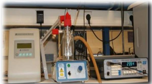
Este instrumento contiene una célula de conductividad que consta de dos electrodos de platino, que están separados una cierta distancia, en un cuerpo de vidrio.
